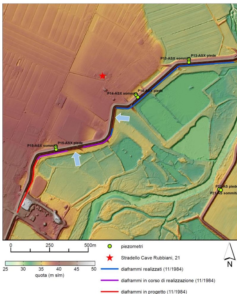
Figura 69. I tratti di arginatura in cui i diaframmi erano già stati realizzati (linea blu), in corso di realizzazione (linea viola), in progetto (linea rossa) nel novembre del 1984. Le due frecce in azzurro evidenziano le porzioni di arginatura in cui il diaframma non è presente. Entrambe queste porzioni sono tra la sezione ST4SX (piezometri P14-ASX) e ST8SX (piezometri P15-ASX) in prossimità di stradello Cave Rubbiani.
